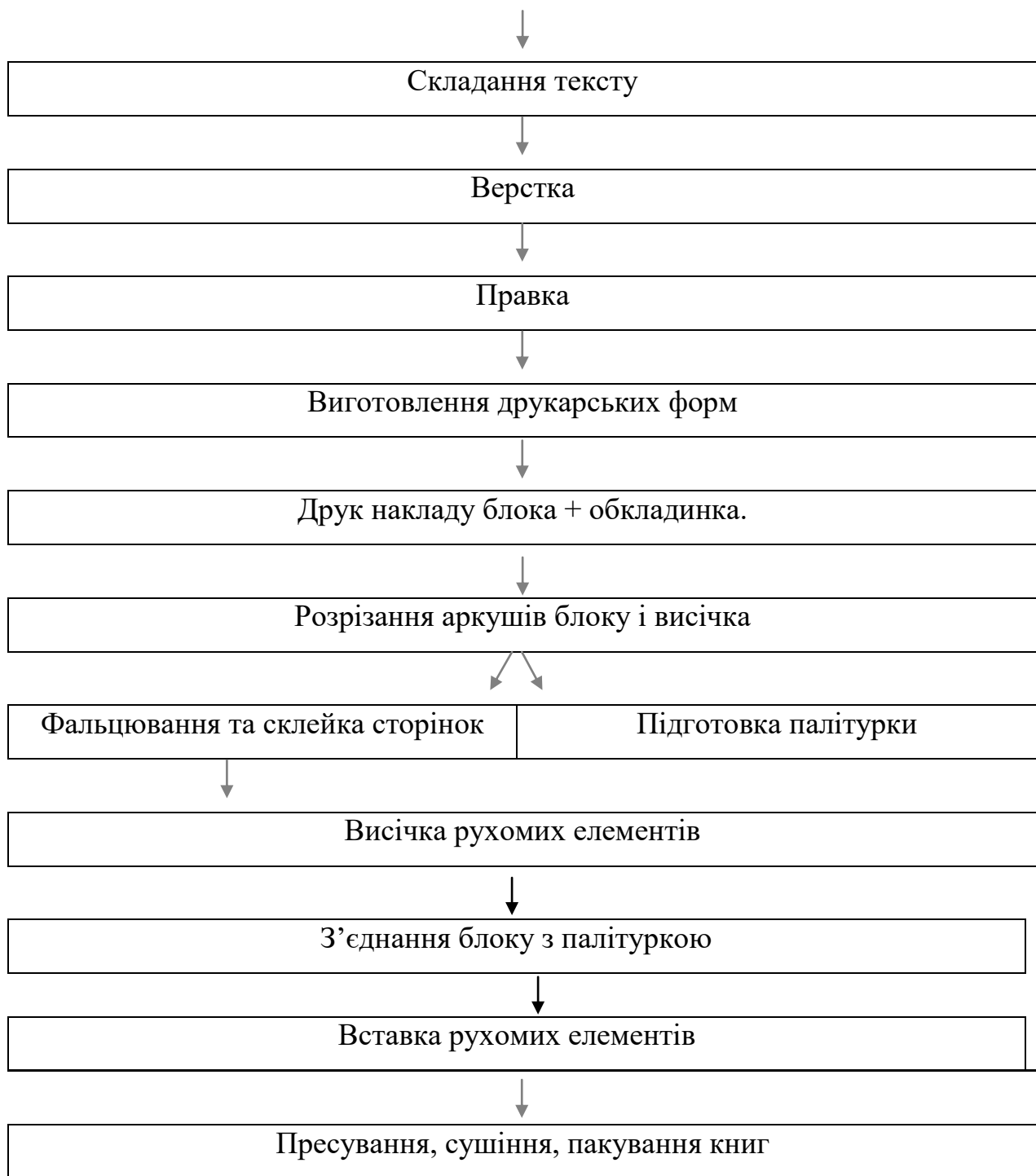
Рис. 2.1. Приклад блок-схема технологічного процесу
